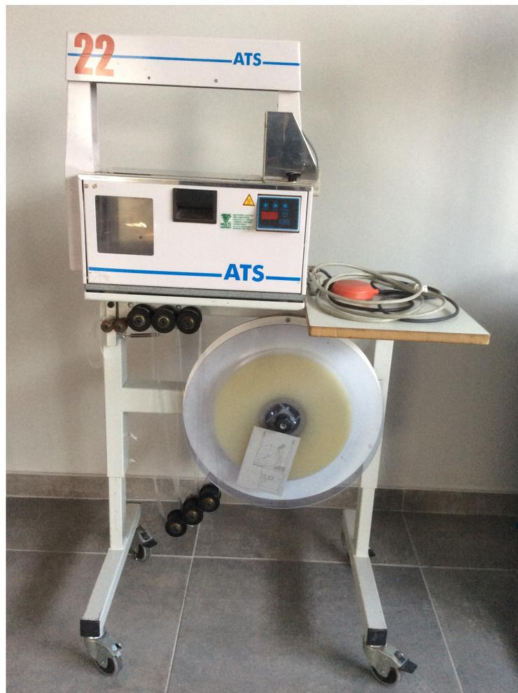
Macchina automatica per la fascettatura semplice e veloce con l'impiego di nastri in carta speciale e polipropilene.
